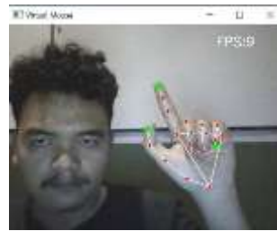
Gambar 6. Hasil deteksi landmark pergerakan kursor
