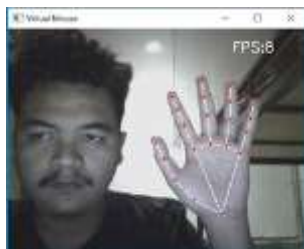
Gambar 5. Hasil deteksi landmark tangan
