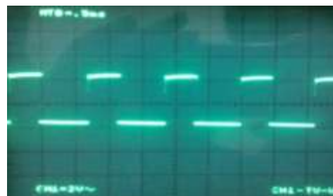
10(a). Hasil Konverter Level DC ke sinyal AC dari IC-555
