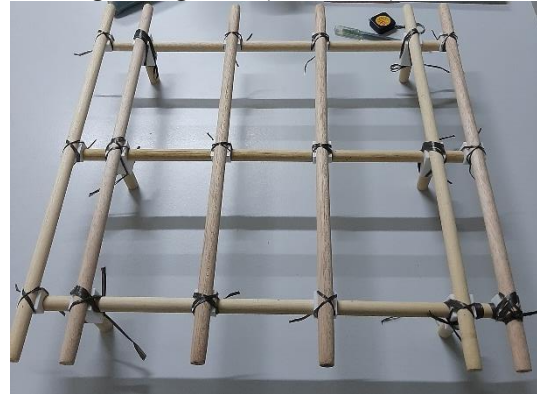
Gambar 15. Sambungan yang diperkuat dengan ikatan tali.
