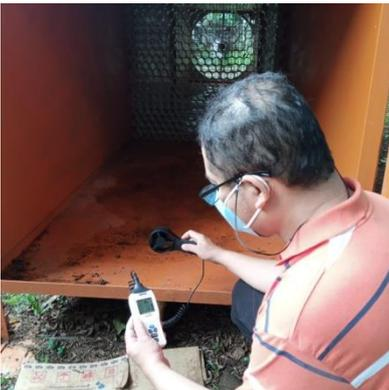
**Gambar 9.** Proses pengambilan data kecepatan angin
